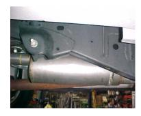
INSTALL MUFFLER # B ONTO HEADPIPE 1 ½" TO 2". USE CLAMP # E TO SECURE MUFFLER TO HEADPIPE. DO NOT TIGHTEN. USE A JACK STAND TO HOLD UP THE MUFFLER. MUFFLER INLET IS LOOKING INTO THE LOUVERS. OUTLET SHOULD BE AT THE 12 O'CLOCK POSITION.
